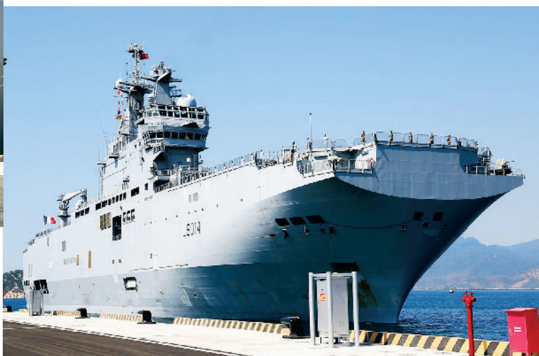
Ngày 2/5/2016, tàu đổ bộ tấn công cỡ lớn lớp Mistral Tonnerre của Pháp cập cảng Cam Ranh. Tàu có lượng giãn nước 21.500 tấn, dài 199,75m, rộng 32m, chiều cao tối đa 48m; mang theo 5 máy bay trực thăng, xuống cao tốc L-CAT và 2 xà lan chở hàng. Tàu có chức năng như là một bộ chỉ huy trên biển, có sân bay trực thăng, bệnh viện...
