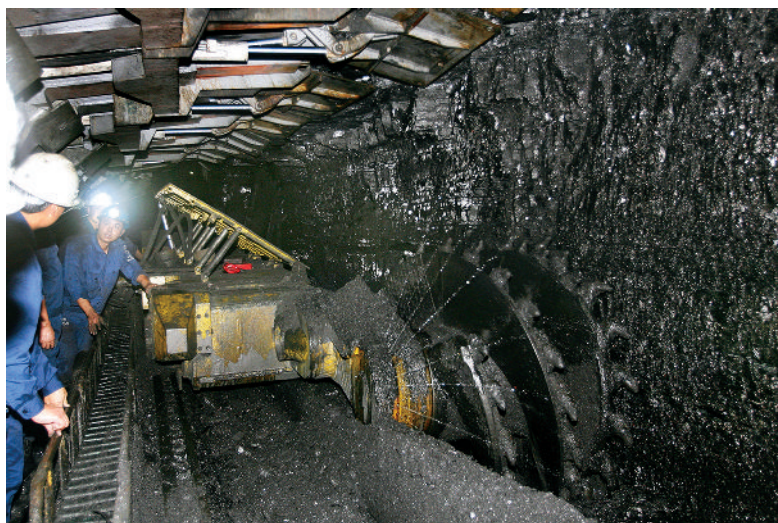
Khai thác than lò chợ.
